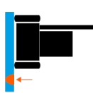
PC : soudage en corniche
