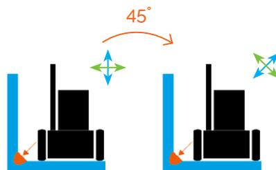
Possibilité de **modifier l'orientation des axes** linéaires d'oscillation et de déplacement de façon logicielle.
