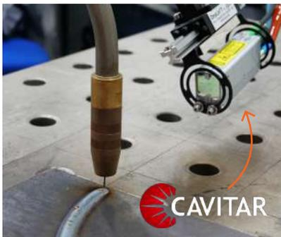
Une caméra de soudage révolutionnaire basée sur une **technologie d'illumination laser** permettant de **voir à travers l'arc** de soudage.
